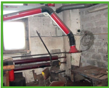
Darba vietu aprīkošana ar pārvietojamu atsūces ventilāciju ļauj ievērojami samazināt metināšanas aerosolu koncentrāciju darba vietā un samazināt saslimšanas riskus
